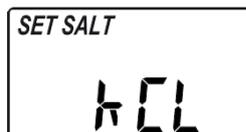
1 – Appuyez sur les flèches ▲ ou ▼ pour sélectionner le type de sel utilisé pour votre adoucisseur. Par défaut le sel programmé est NaCl (sel standard à base de Chlorure de Sodium). Si vous utilisez du KCl (sel à base de Chlorure de Potassium), sélectionnez kCL. Ce réglage permet d'ajuster la durée des cycles de régénération pour compenser les différents taux de dissolution du KCl.
