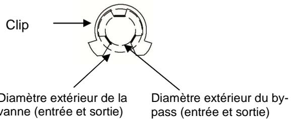
**NOTE :** Assurez-vous que les 3 ergots des clips sont bien passés dans les 3 trous les recevant en Entrée (IN) et Sortie (OUT).
