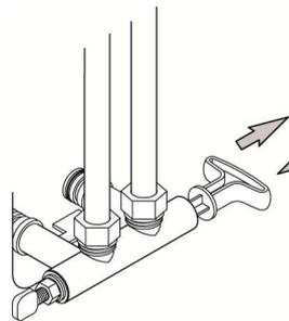
Tirez pour être en position service (passage de l'eau dans l'appareil)
