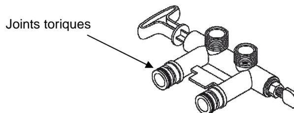
5. Insérer le by-pass dans la vanne par le haut ou par le bas en fonction de l'emplacement de l'arrivée d'eau.
